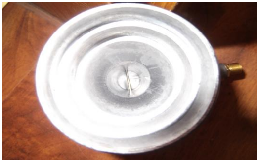
Kleine Stab – Antenne im LNB
