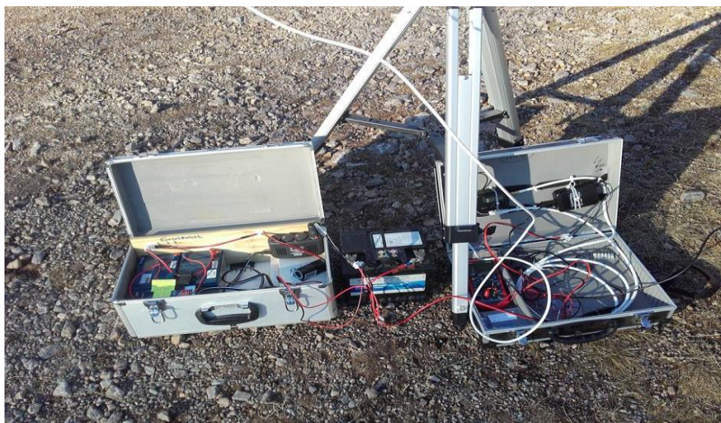
Koffer links: Autobatterie 12V; Koffer rechts: Satfinder und Netzteil
