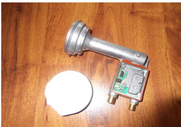
LNB auseinander gebaut
